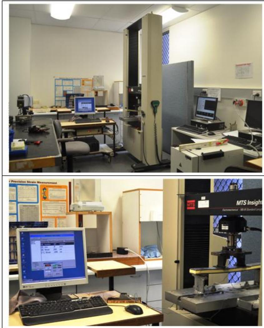
Figure 5.4. The actual set up of flexural test
