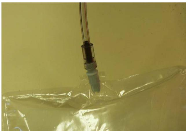
(d) Valve assembly on the sample gas bag.
