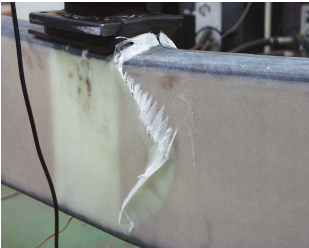
Figure E.11 (d) Final Failure Initiated Beside Load Pad
