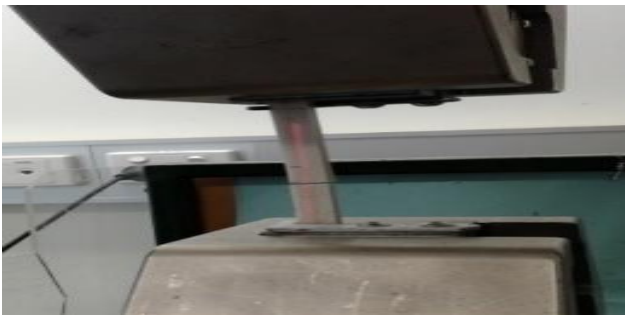
Fig. 1 Tensile test coupon
